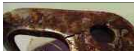
Ρηγμάτωση σε σκουριασμένη πλακέτα
